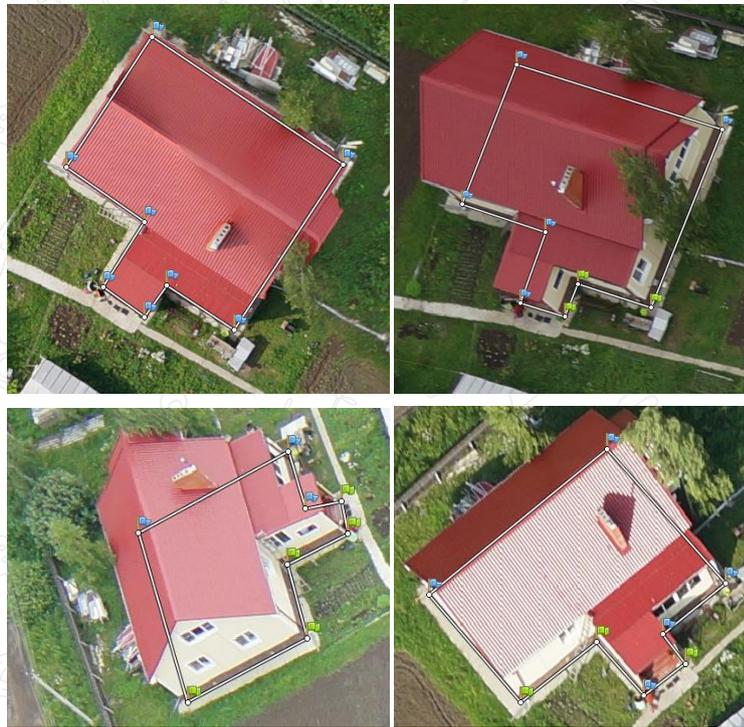
Испытания ФГБУ «Центр геодезии, картографии и пространственных данных» подтверждают точность определения координат картометрическим методом по ортофотоплану на уровне 5-9 см и фотограмметрическим методом по снимкам на уровне 4-5 см для высоты полета БЛА Геоскан 200-400 м (в ПО Agisoft PhotoScan Pro)
